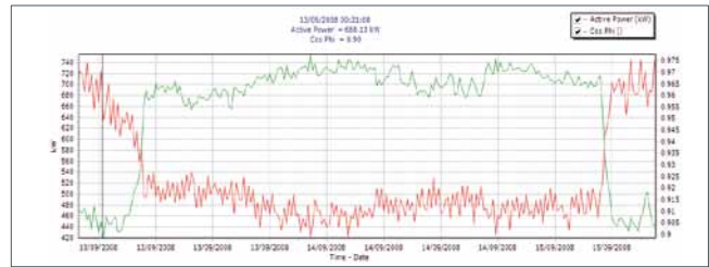
Fig. 3: Rapport de compteur principal du site. Le graphique montre la consommation de l'électricité (puissance active) et le facteur de puissance en intervalles de 15 minutes. Le weekend, la consommation baisse et le facteur de puissance s'améliore car il y a moins de machines en production. Le facteur de puissance reste toujours plus haut que 0,9 ce qui indique une situation acceptable. Le graphique est souvent utilisé pour contrôler le fonctionnement des batteries de condensateurs.
