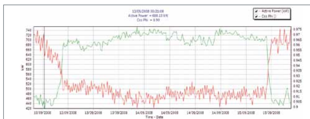
▲ Fig. 3: Report di visione generale del contatore principale della fabbrica. Il consumo di elettricità (potenza attiva) e il relativo fattore di potenza (cos phi) sono rilevati ogni 15 minuti. Durante il weekend, solo poche macchine sono in produzione, e come risultato la potenza attiva decresce e il fattore di potenza migliora. Il grafico mostra che il fattore di potenza rimane sempre sopra lo 0,9 ad indicare una situazione accettabile. Questo grafico consente anche di valutare il funzionamento della batteria del condensatore per migliorare il fattore di potenza.
