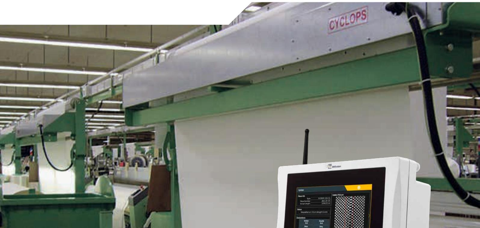
**Dieses System für die automatische Warenschau an der Webmaschine erkennt Kett-, Schuss- und Punktfehler mittels eines am Steigdockenwickler changierenden Kamerasystems.**
