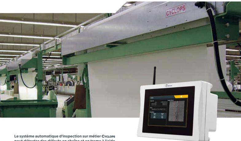
Le système automatique d'inspection sur métier CYCLOPS peut détecter des défauts en chaîne et en trame à l'aide d'une caméra visualisant le tissu par un mouvement de va-et-vient. Il peut être installé sur l'enrouleur séparé ou intégré dans le métier à tisser.
