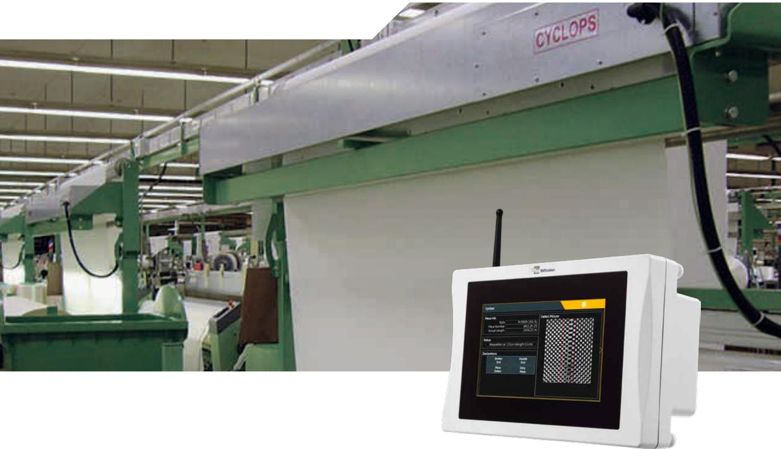
BMSvision 织布机实时自动监察系统使用移动照相机安装在出布罗拉上或布机组合，扫描检测织物上的经纱和布面疵点。系统探测到经纱或其它表面连续性疵点，机台立即停止。灯柱警报灯闪亮，并通知织机微处理器，记录疵点特性和位置。织机保持停止状态，直至值车工将“疵点处理”，讯号输入报告内。通过 WeaveMaster 监察系统，将所有疵点数据和有标记的疵点数据传送到织物质量数据库，以便制订布面疵点分布图和各类质量报告。
