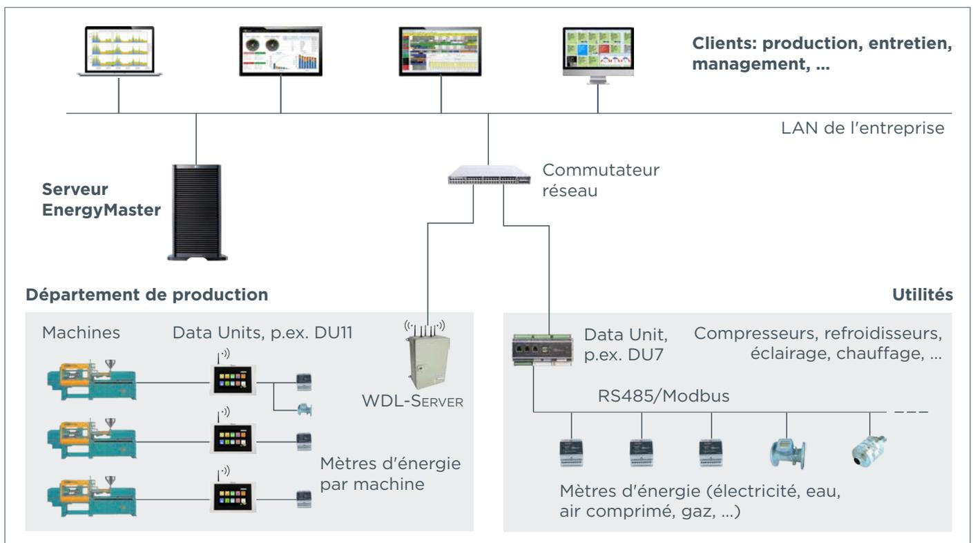
Le concept d'ENERGYMASTER. Les Data Units BMSvision déjà installées peuvent être utilisées pour la collection des données des compteurs. Ces données sont transférées vers le serveur ENERGYMASTER via le réseau BMSvision disponible (câblé ou sans fil). Pour les nouvelles installations, le réseau sans fil est le meilleur choix.
