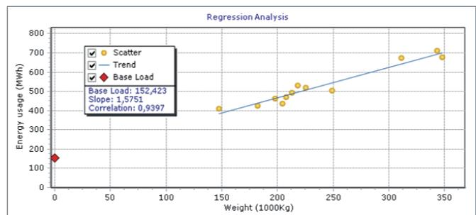
Ligne de Caractéristique de Performance (LCP) pour un site d'injection avec une charge de base de 152 MWh/mois et une consommation de transformation de 1,5 kW par kg matière plastique. Dans l'extrusion par contre, la consommation de transformation équivalait à moins de la moitié que celle observée dans l'injection.
